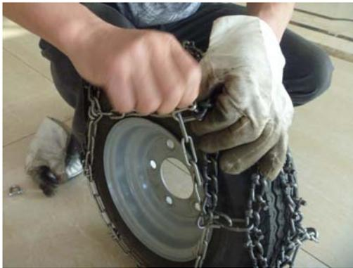
FI: Työnnä kiinnityskoukku sopivan ketjulenkin läpi ja kiinnitä koukku sivuketjuun siten, että ketju on sopivan kireällä.
