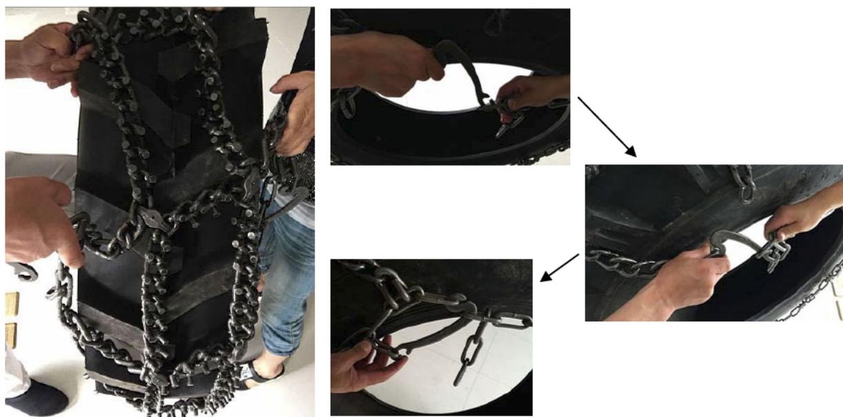
FI: Kiinnitä ketjun päät sivuketjuun sakkeleiden avulla (sisältyvä toimitukseen). Varmista, että ketjut asettuvat tiukasti rengasta vasten eivätkä ole löysällä.
