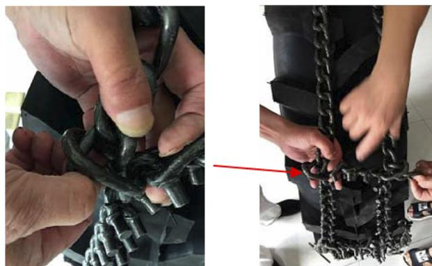
FI: Työnnä kiinnityskoukku sopivan sivuketjulenkin läpi ja kiinnitä koukku siten, että ketju on sopivan kireällä.
