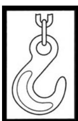
Merkintä, joka ilmoittaa kohdat, joista laitetta voi nostaa nostovälineillä (tarra juontokouran rungon pinnassa).
