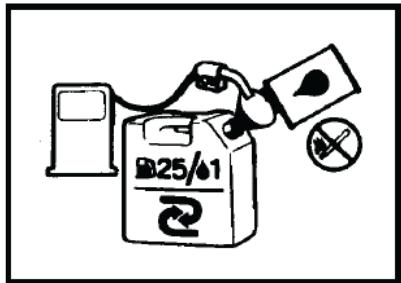
Sekoita bensiiniä (lyijytöntä tai lyijyllistä, ei saa sisältää etanolia) ja laadukasta, ilmajäähdytteiseen kaksitahtimoottoriin tarkoitettua moottoriöljyä.
