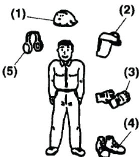
**A.** När du använder röjsågen ska du använda lämplig klädsel och skyddsutrustning enligt följande:
