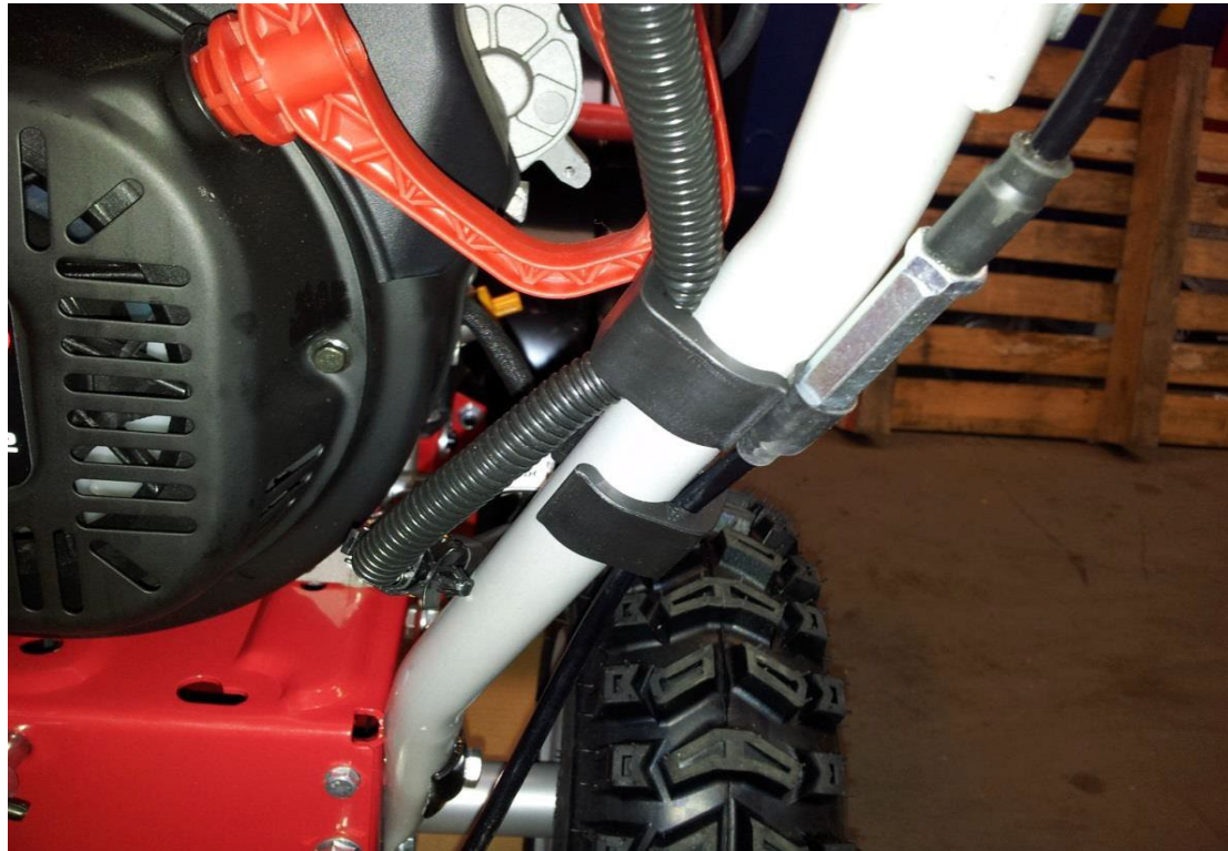
Vaijerit kiinnitetään kahvaan pidikkeellä
