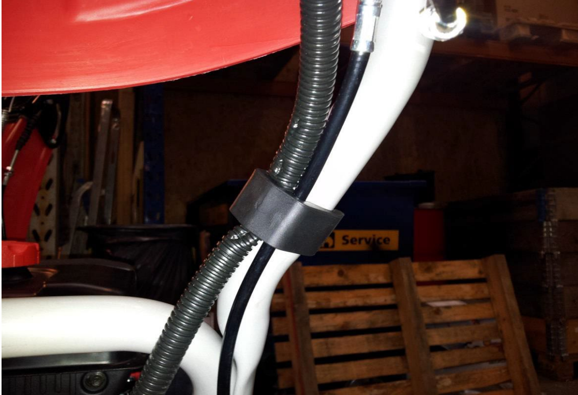
Vaijerit kiinnitetään kahvaan pidikkeellä
