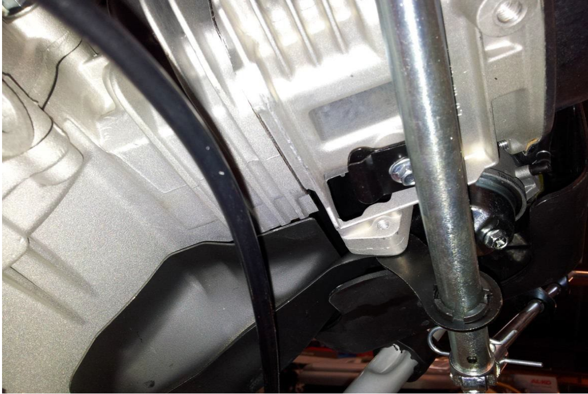
Linkousosan kytkinvaijeri asetetaan pidikkeeseen moottorin alla.
