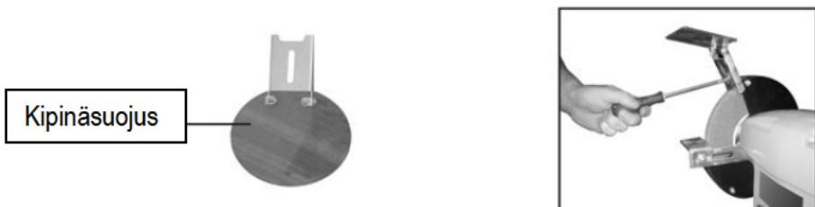
Kipinäsuojuksen on oltava asennettuna ennen laitteen käyttöönottoa.
